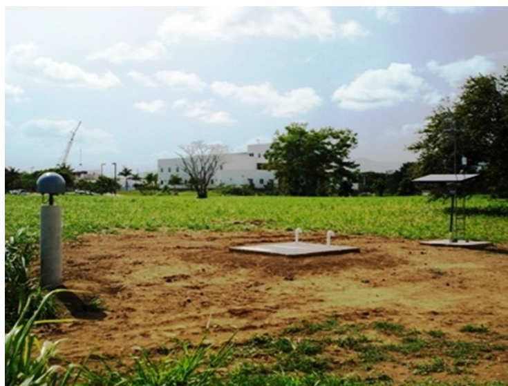
Figura 16. Estación sísmica instalada en las facilidades de la Universidad Interamericana en Guayama (IGPR) (RSPR-UPRM).
