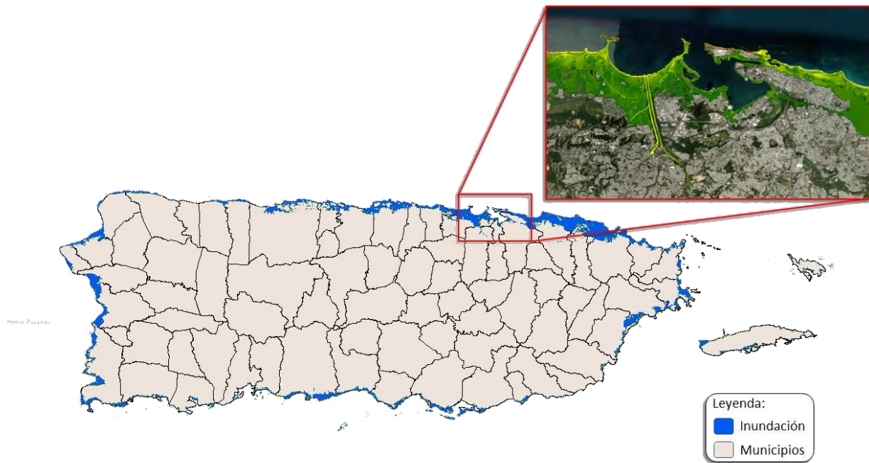
Figura 6: Polígono de la zona de inundación por tsunami, modelo 2012 (tomado y adaptado del Puerto Rico Tsunami Program Map Tool , RSPR, http://www.prtdst.uprm.edu ).
